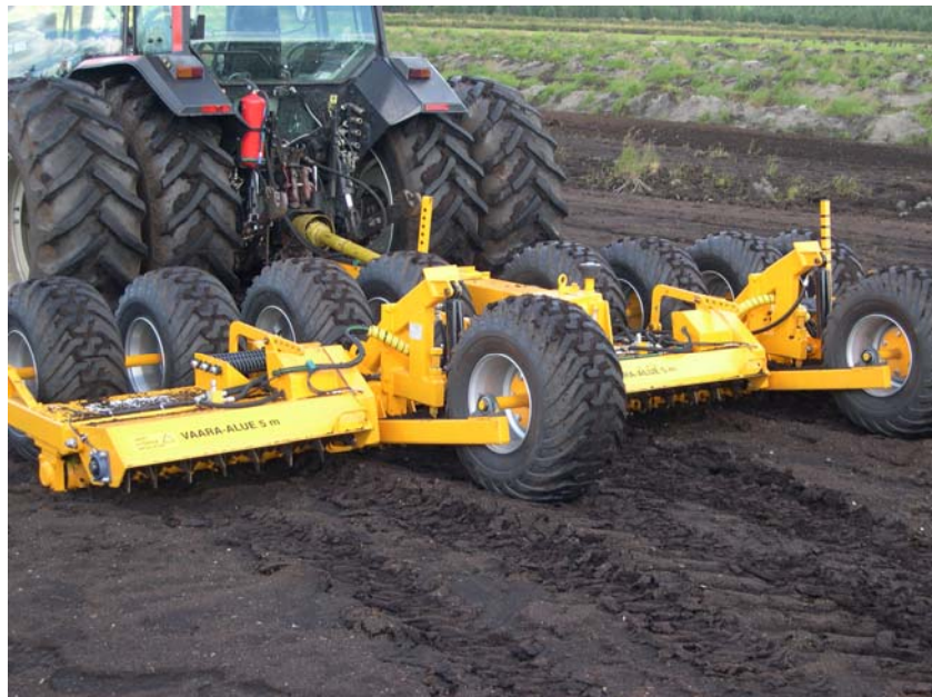
Kuva 2. Tiivisturve tuotetaan tuotantoon erityisesti suunnitellulla jyrsimellä.
